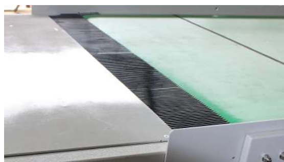
SISTEMA ASPIRAZIONE TRUCIOLI DISPOSTO TRA LA MACCHINA E IL TAPPETO
